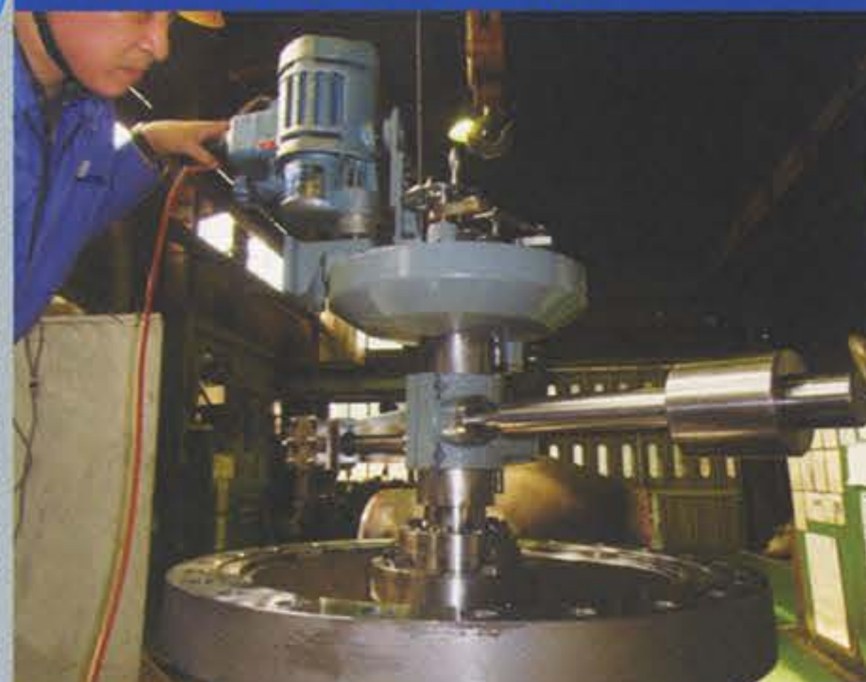
ガスケット面の修正加工
