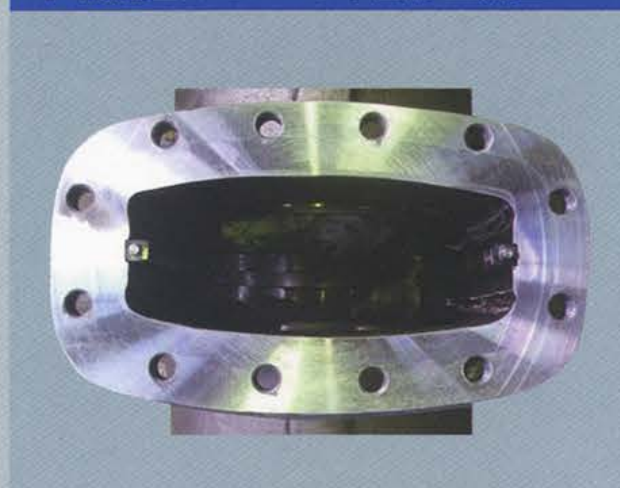
小判胴型のガスケット面修正加工
