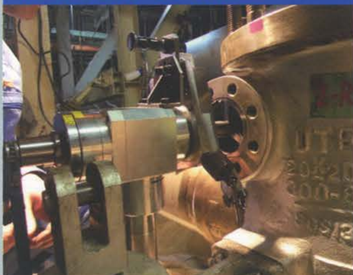
軸受部ガスケット面加工
